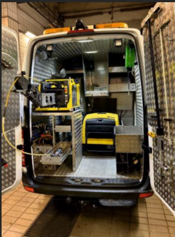
Flexibilität und effizientes Arbeiten steht bei uns immer im Vordergrund, daher ist unser Druckprüfgerät mit einer vollwertigen Inspektionskameraeinheit kombiniert.
