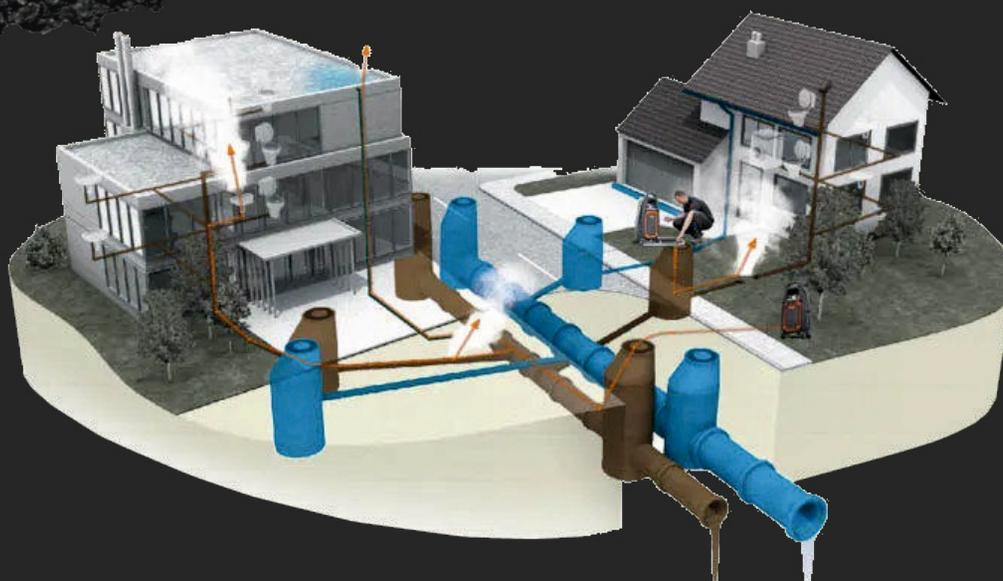
Die Kanalberauchung ist mitunter die effektivste Form der Fremdwassersuche, wenn es darum geht falsch angeschlossene Objekte ausfindig zu machen.
