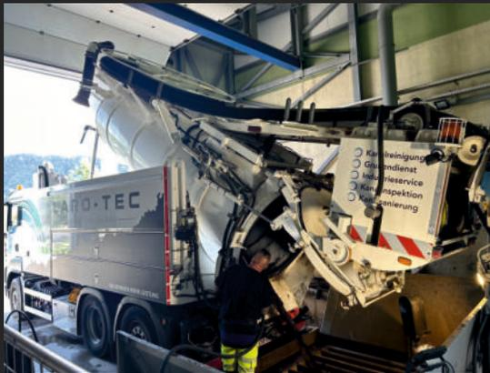
Schnelle und effiziente Entleerung des Schlamm tanks. Dieser kann 45° gekippt werden, um das Räumgut auf einfachsten Wege abzuladen. Flüssigkeiten werden sauber über einen Schlauch und wenn Nötig mit zusätzlichem Druck abgelassen.
